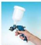
Le pistolet se tient comme sur la photo ci-dessus entre 10 et 20 cm du support, la molette de réglage du jet doit être ouverte au max et le débit varie en fonction de la pression.
